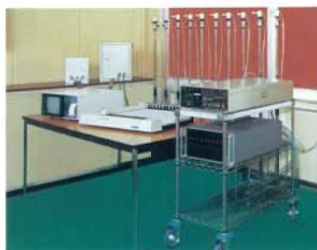
ダスト集中管理システム マルチセレクト方式
