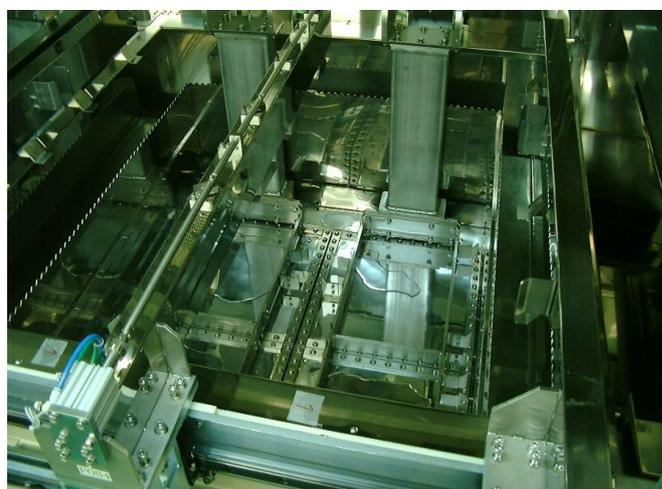
洗浄槽（超音波槽）
